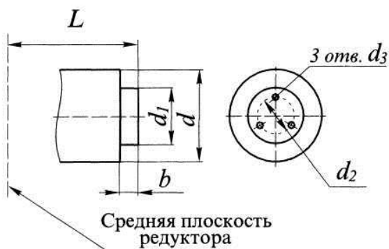
Присоединительные размеры тихоходного вала для присоединения приборов управления
