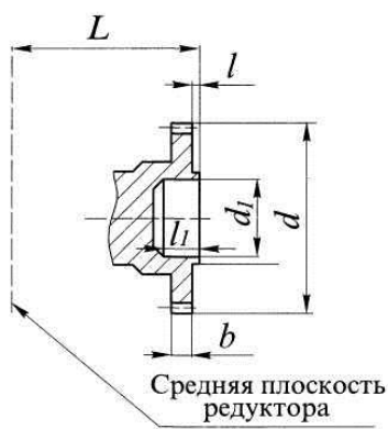
Присоединительные размеры выходных валов в виде зубчатой полумуфты
