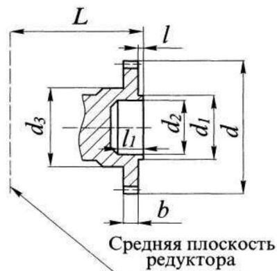
Присоединительные размеры тихоходного вала в виде зубчатой полумуфты
