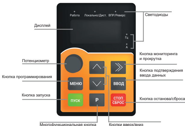
Рис. 5.1. Функции кнопок и светодиодов панели управления SDI
