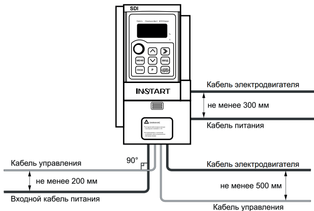
Рис. 3.6 Графическое представление расстояний между кабелями
